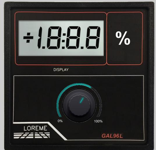
Le GAL96L est un générateur de consigne analogique auto-alimenté par la boucle 4...20mA. Il permet de contraindre le courant dans une boucle disposant de son alimentation, il peut par exemple remplacer un convertisseur en technique 2 fils pour simuler la mesure dans une boucle 4...20mA. La sérigraphie de l'unité de mesure sur la face avant peut être réalisée sur simple demande.
