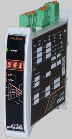
Le GNL35LA est un générateur de consigne format rail DIN à réglage digital par bouton poussoir entièrement configurable en face avant. Il dispose d'une alimentation auxiliaire universelle Dc et AC de 20 à 265V.
